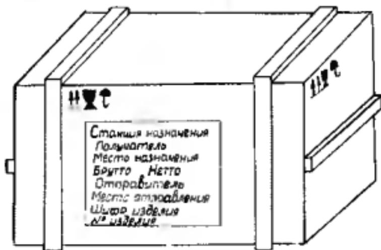
Рис. 14. Размещение маршировок и односторонних надписей на транспортном ящике
